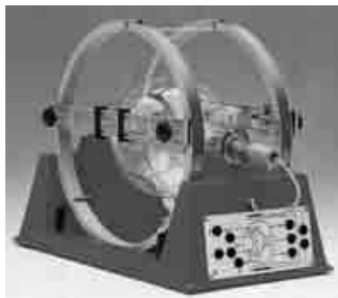
Hình 32.1 Thí nghiệm về chuyển động của êlectron trong từ trường.
