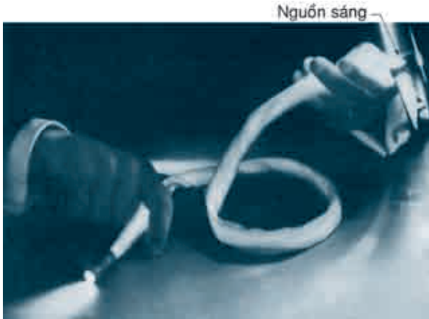
Hình 45.5 Ánh sáng được dẫn qua sợi quang do hiện tượng phản xạ toàn phần.
