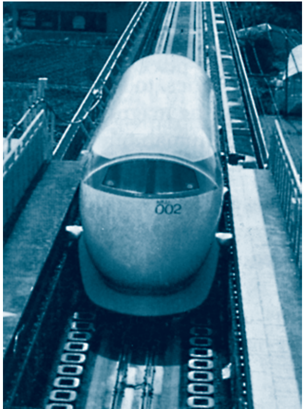
Hình 18.4. Tàu hoả đệm từ ở Nhật Bản đạt tốc độ kỉ lục 516 km/h.
